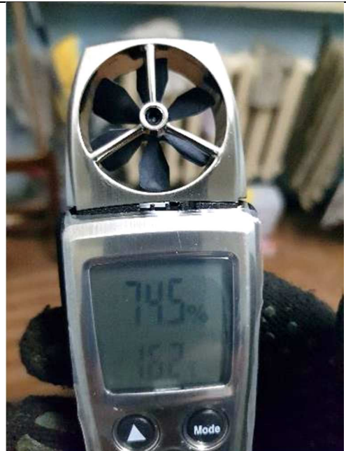
Фото 36. Определение относительной влажности воздуха в подвальных помещениях
